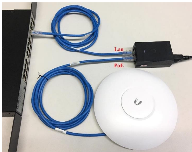
รูปที่ 4.7 แสดงภาพการเชื่อมต่อ UniFi AP เพื่อ Reset config
