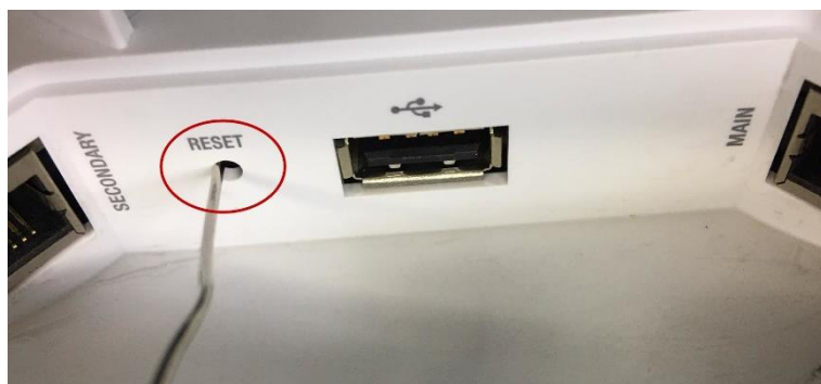
รูปที่ 4.8 แสดงภาพการเชื่อมต่อ Reset UniFi AP
