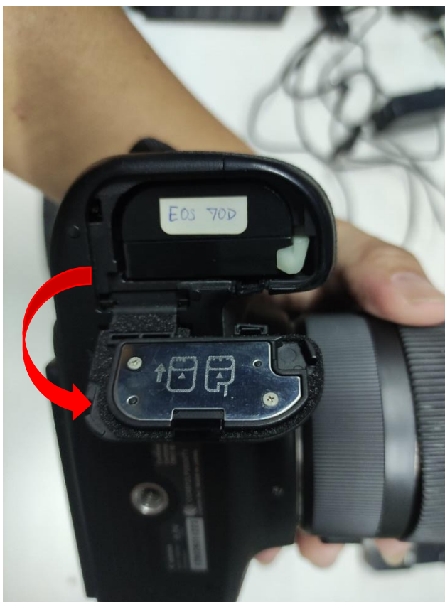
ภาพที่ 4.7 การเปิดฝาแบตเตอรี่ของกล้อง DSLR
