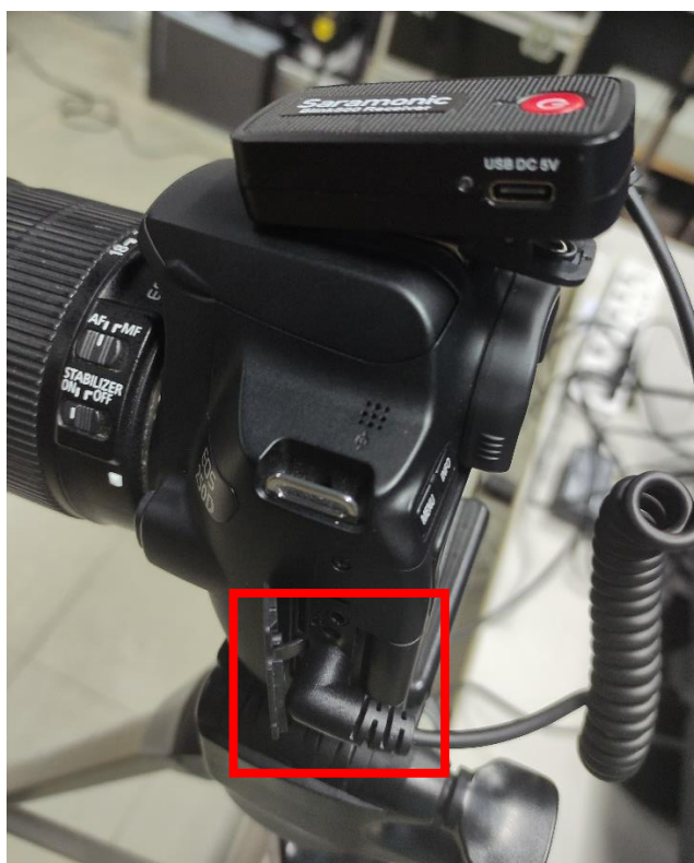
ภาพที่ 4.71 การรวมสัญญาณเสียงจากตัวรับเข้ากับกล้องสำหรับการบันทึกวิดีโอ
