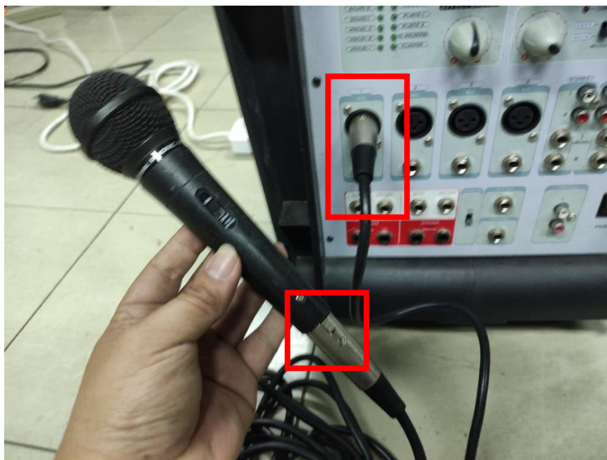
ภาพที่ 4.128 การเชื่อมต่อสายสัญญาณเสียงจากไมโครโฟนกับเครื่องเสียง Amplifier นำสายสัญญาณเสียงหัวสีแดงที่เป็นหัวต่อแบบ Phone ต่อเข้ากับลำโพงทั้ง 2 ตัว โดย ปลายสายอีกฝั่งต่อเข้ากับตัว Amplifier ในช่อง Speaker Left/Main บริเวณแถวล่างสุด ของเครื่องเสียง
