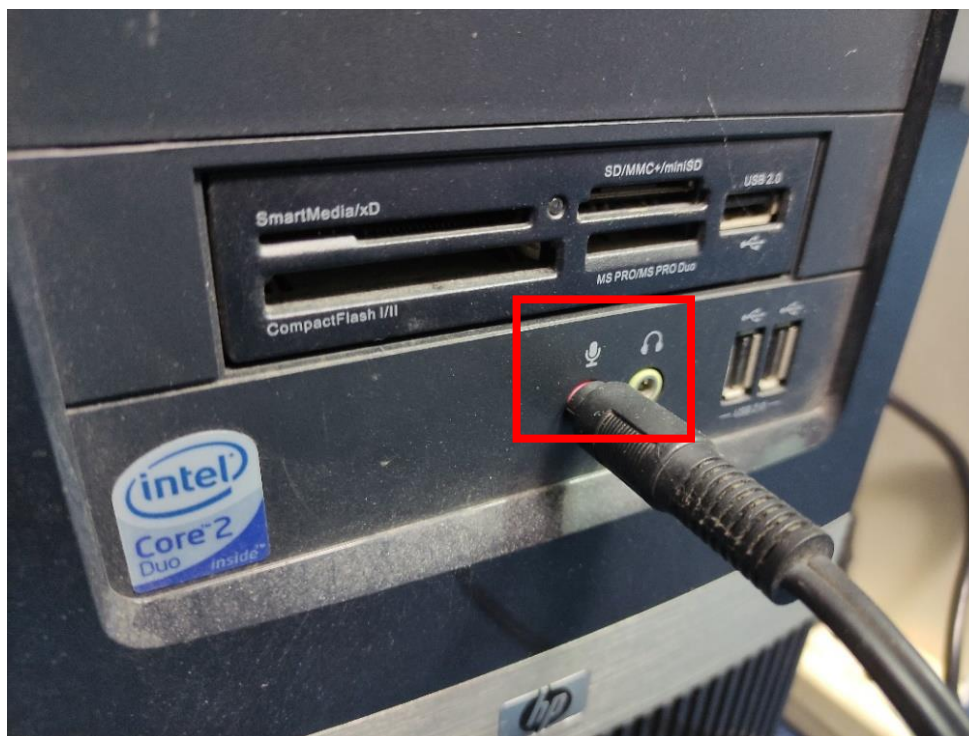
ภาพที่ 4.102 ช่องนำสัญญาณเสียงเข้าคอมพิวเตอร์เพื่อทำการบันทึกเสียงผ่านโปรแกรม
