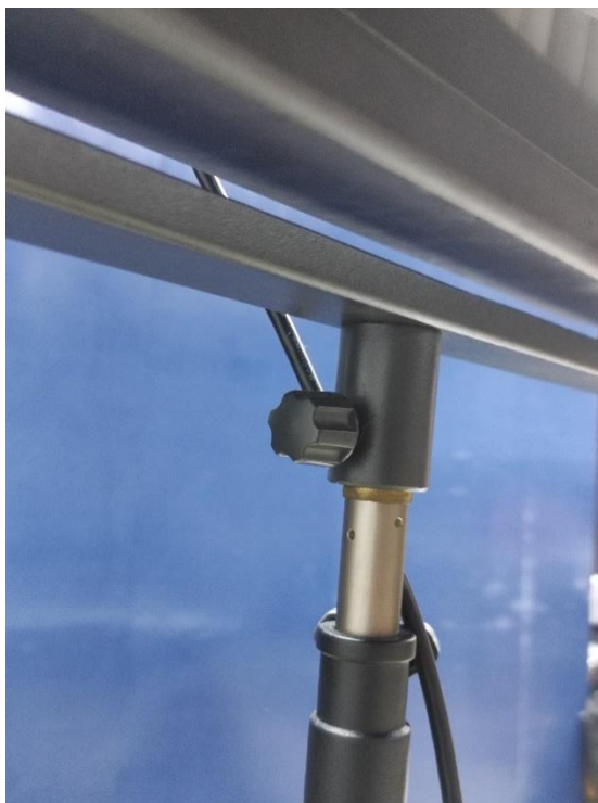
ภาพที่ 4.44 จุดหมุนเพื่อยึดแผงไฟกับขาตั้งไฟสตูดิโอ
