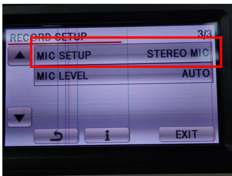
ภาพที่ 4.33 การตั้งค่าเสียงจากไมโครโฟนของกล้องวิดีโอ
