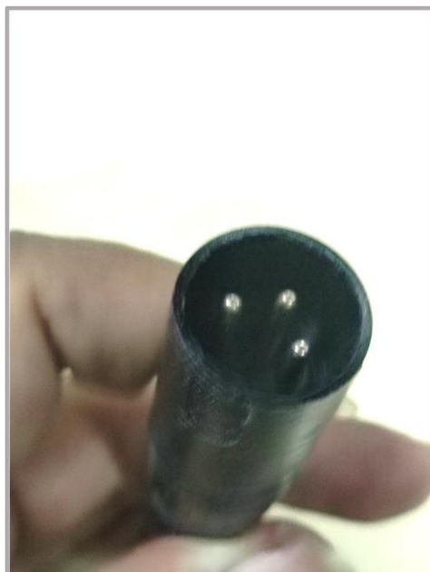
ภาพที่ 4.57 ลักษณะของปลายสายสัญญาณชนิด XLR
