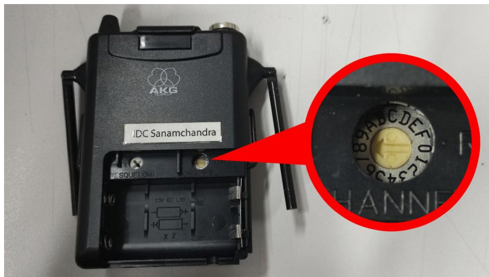
ภาพที่ 4.53 แสดงการปรับจูนคลื่นของไมโครโฟนทั้งตัวรับและส่ง ต่อสายสัญญาณรับและส่งเข้ากับตัวอุปกรณ์บริเวณช่องเสียบด้านบนของ อุปกรณ์ทั้งตัวรับและตัวส่ง
