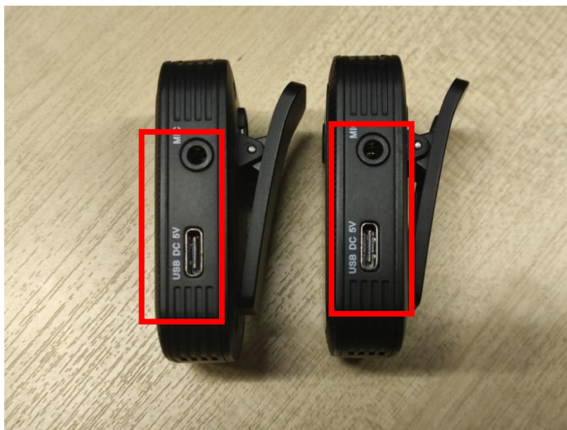
ภาพที่ 4.62 ช่องเสียบไมโครโฟนชนิด Lavalier และช่องสำหรับการชาร์จแบตเตอรี่ ภายในชนิด USB-C ของตัวส่งสัญญาณเสียง
