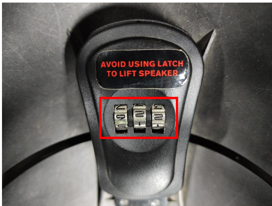
ภาพที่ 4.123 การปลดล็อกเพื่อถอดประกอบเครื่องเสียงด้วยตัวเลข 3 หลัก เมื่อทำการปลดล็อกแล้วให้ส่วนประกอบสำคัญออกมาเป็น 3 ชิ้น คือ ส่วนของ Amplifier ส่วนของลำโพงซ้าย และส่วนของลำโพงขวา
