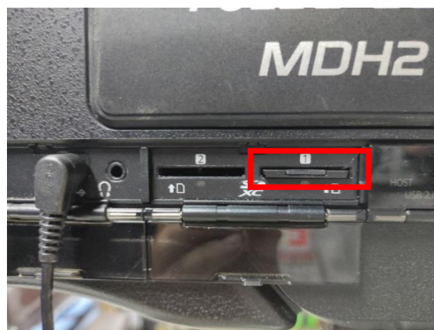
ภาพที่ 4.25 ช่องใส่ SD Card บริเวณใต้ฐานของ กล้องวิดีโอ
