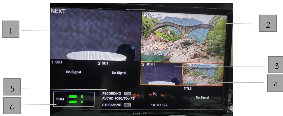
ภาพที่ 4.78 สัญญาณภาพแสดงผลผ่านจอ Monitor ทางช่อง Multi Viewer
