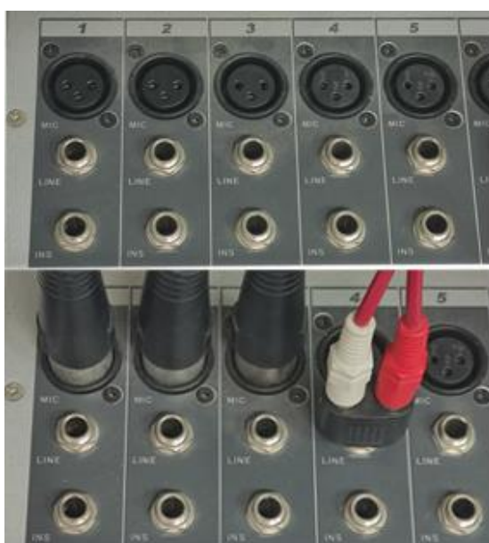
ภาพที่ 4.96 ช่องเสียบสายสัญญาณเสียงจากไมโครโฟนและอื่น ๆ
