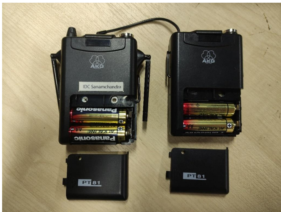
ภาพที่ 4.52 แสดงการใส่แบตเตอรี่ของไมโครโฟนไร้สาย
