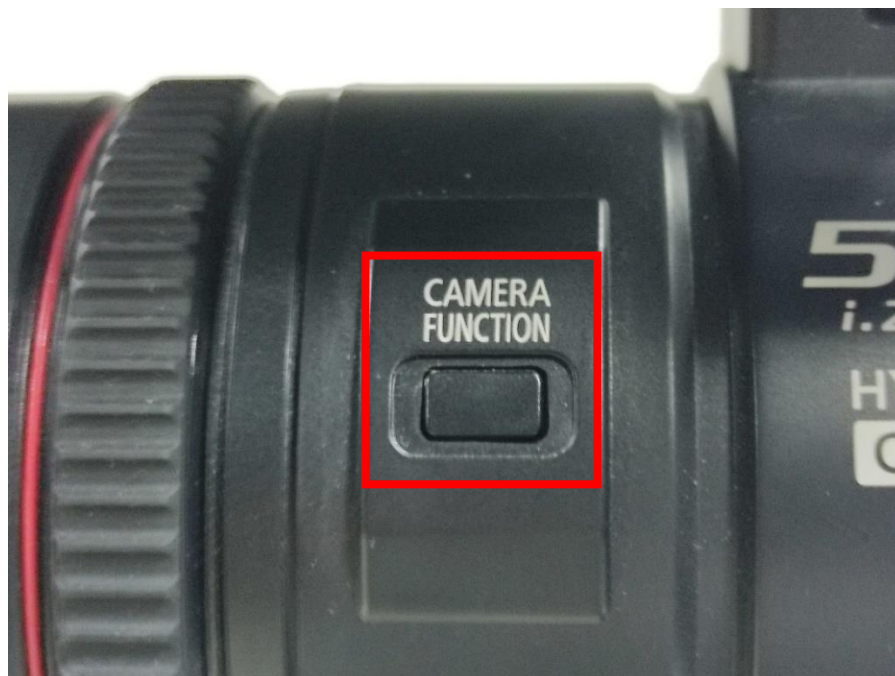
ภาพที่ 4.37 ปุ่มสลับการควบคุมการทำงานในเรื่องการโฟกัสของเลนส์
