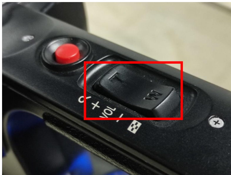
ภาพที่ 4.39 ปุ่ม Zoom in และ out บริเวณด้านจับด้านบนของกล้องวิดีโอ
