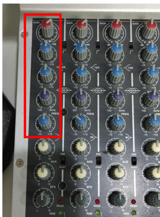
ภาพที่ 4.98 แป้นหมุนสำหรับการเพิ่มและลด Gain และความทุ้มแหลมของเสียง
