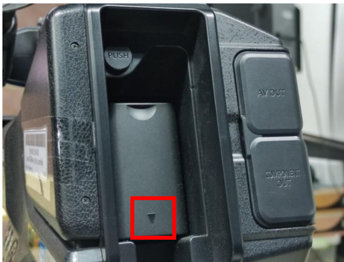
ภาพที่ 4.22 สัญลักษณ์บนแบตเตอรี่สำหรับการใส่บนของกล้องถ่ายวิดีโอ
