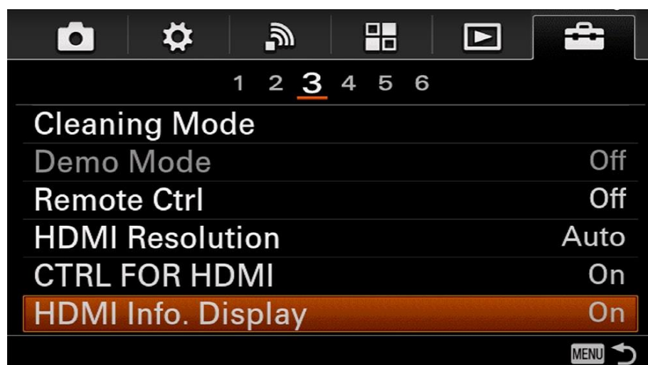
ภาพที่ 4.89 การกำหนดค่าเพื่อทำการ Clean HDMI
