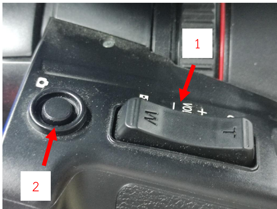
ภาพที่ 4.38 แสดงปุ่มการ Zoom in, Zoom out และปุ่มบันทึกภาพนิ่ง
