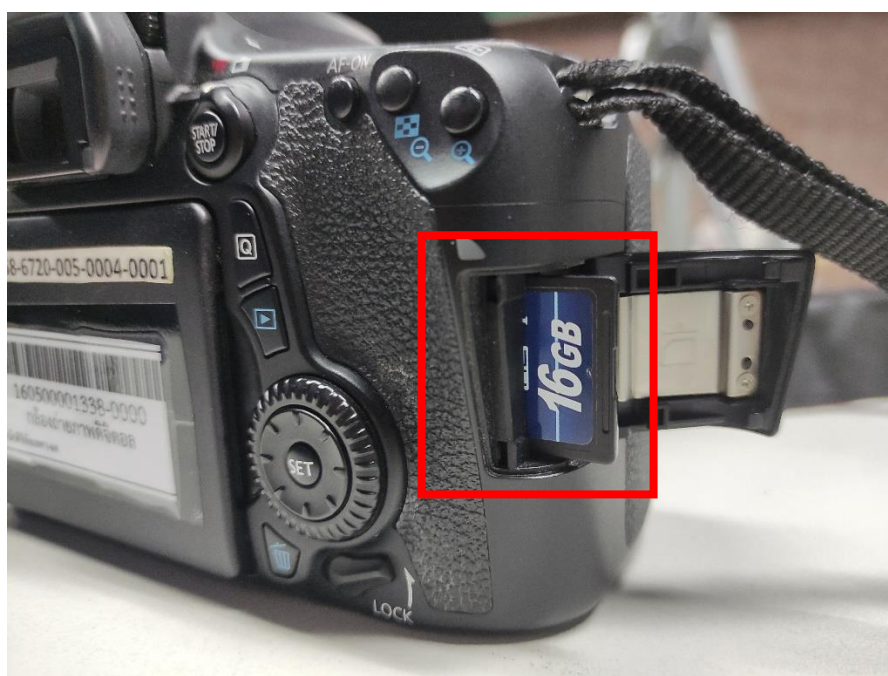
ภาพที่ 4.10 การใส่ SD Card บริเวณด้านข้างของตัวกล้อง
