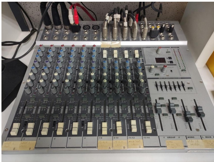
ภาพที่ 4.93 เครื่องผสมสัญญาณเสียงสำหรับการบันทึกเสียง
