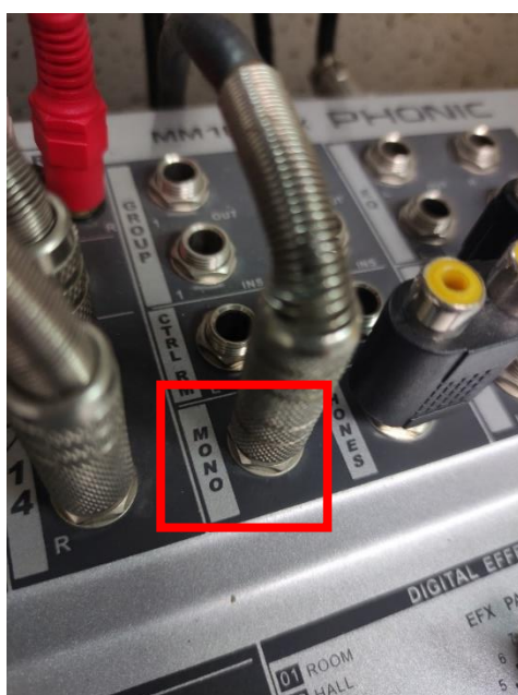
ภาพที่ 4.103 ช่องสำหรับการส่งสัญญาณประเภท Mono ไปยังหูฟัง
