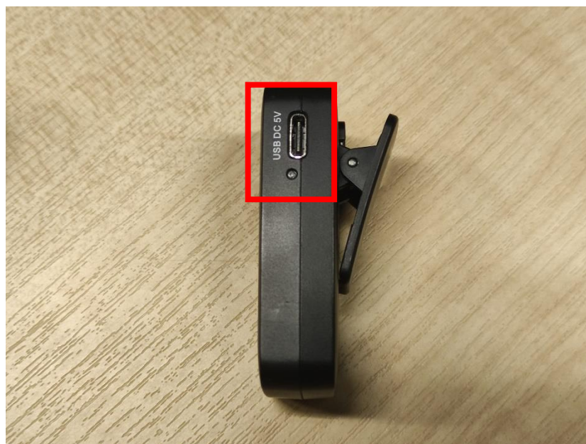
ภาพที่ 4.64 ช่องสำหรับการเสียบชาร์จแบตเตอรี่ภายในของตัวรับสัญญาณเสียง
