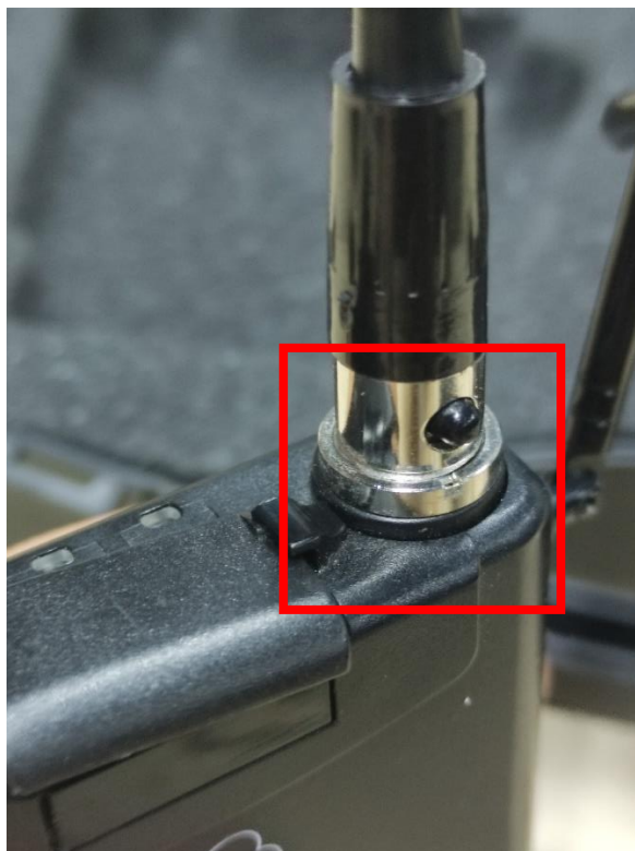
ภาพที่ 4.54 แสดงจุดสวมใส่สายสัญญาณทั้งตัวรับและส่ง เลื่อนปุ่มเปิดการใช้งานของอุปกรณ์ของทั้งตัวรับและตัวส่ง โดยให้มีไฟแสดง สถานะพร้อมใช้เป็นสีแดงปรากฏขึ้นบริเวณข้างปุ่ม หากไม่มีไฟปรากฏให้ทำการ
