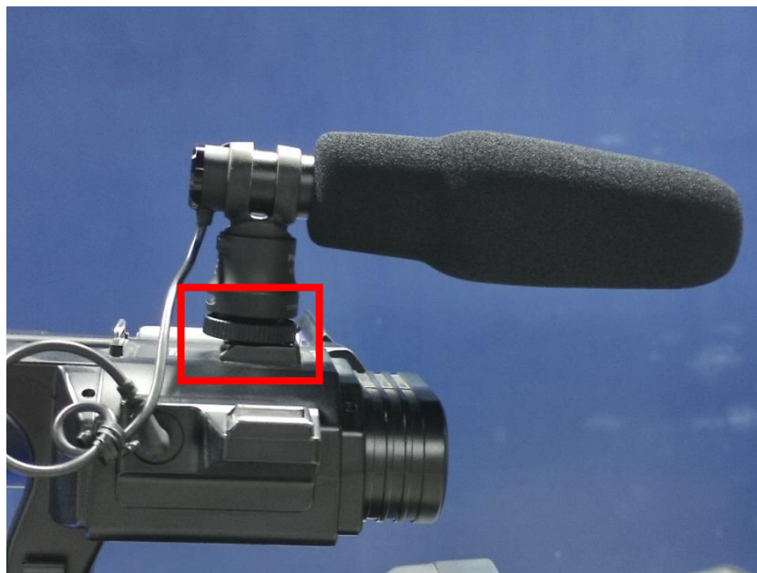
ภาพที่ 4.34 จุดเชื่อมต่อของไมโครโฟนบริเวณด้านบนของตัวกล้องวิดีโอ
