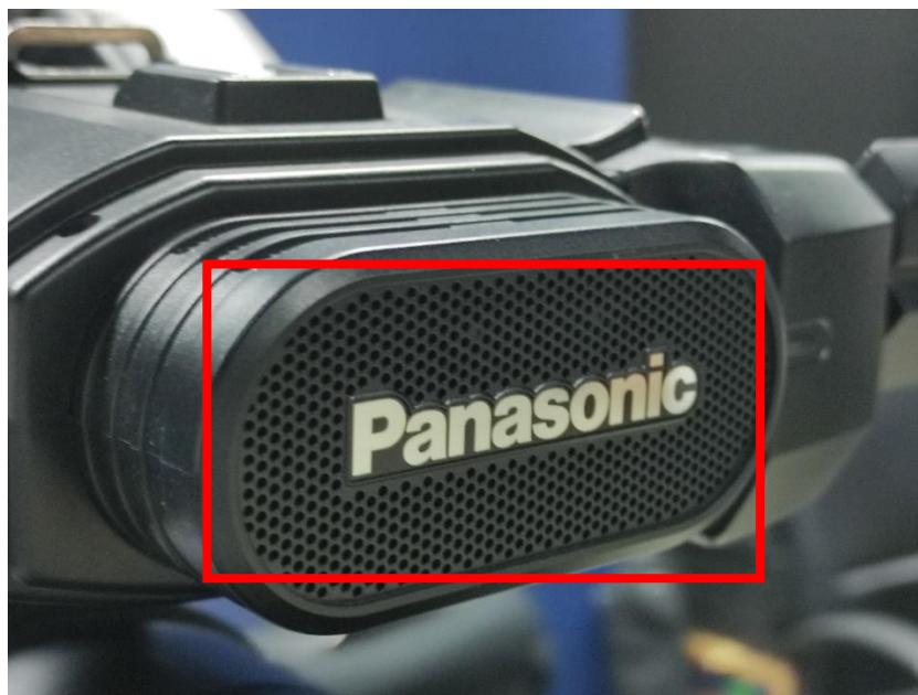
ภาพที่ 4.35 ไมโครโฟนของกล้องบริเวณด้านหน้าตรงสัญลักษณ์ยี่ห้อของกล้องวิดีโอ
