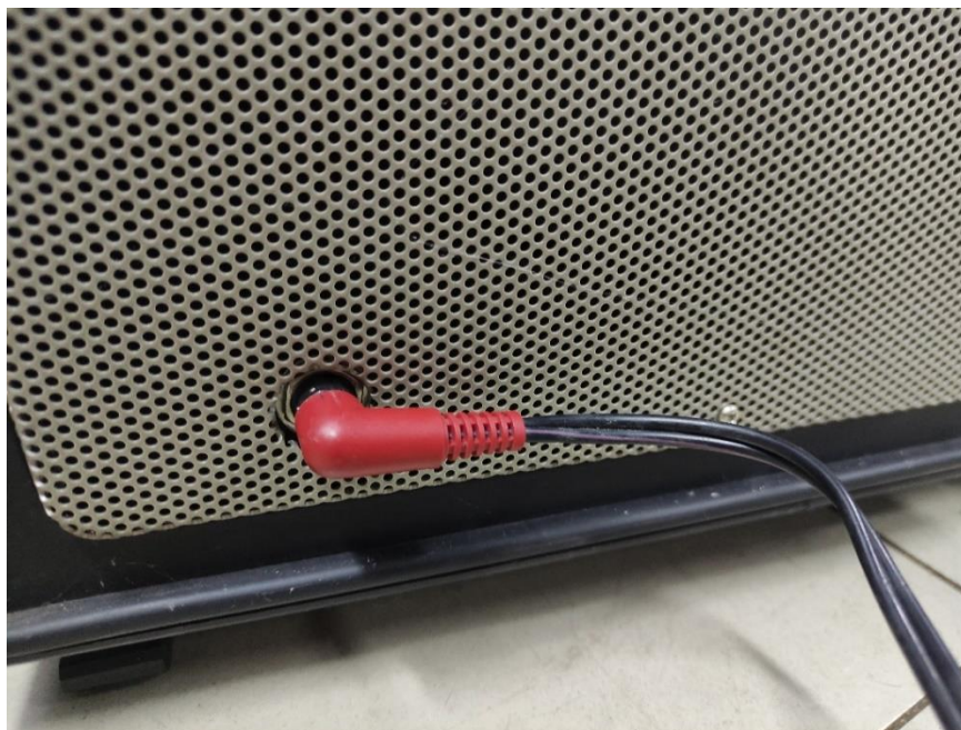
ภาพที่ 4.129 การเชื่อมต่อสายสัญญาณเสียงกับลำโพง
