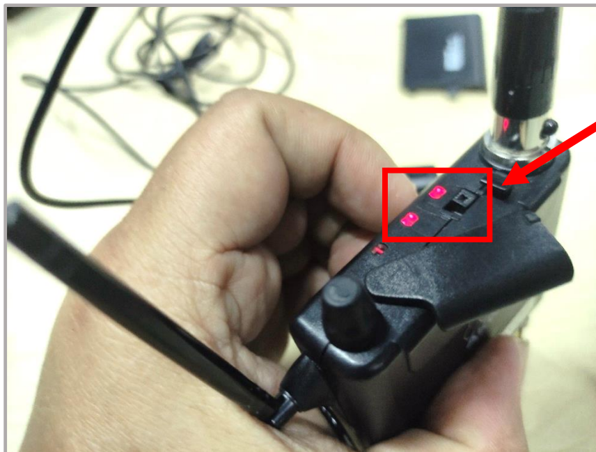
ภาพที่ 4.55 การแสดงไฟสถานะเมื่อเปิดใช้ตัวรับสัญญาณเสียง
